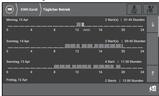
Abb.85 Täglicher Betrieb KWK-Gerät
