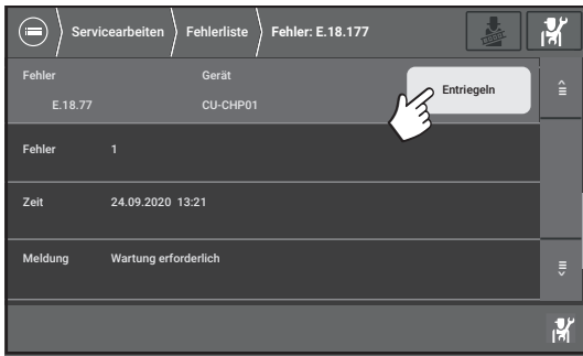
Abb.25 Fehler mit [Entriegeln] entstoren
